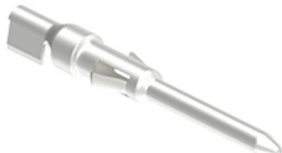
オス 圧着コンタクト, SD シリーズ, 10 A, プレスコンタクト 銀メッキ, 導体断面積 0,37 - 1 mm<sup>2</sup>, AWG 24 - 18, バラピン, リールパッケージ, 500嵌合サイクル用
