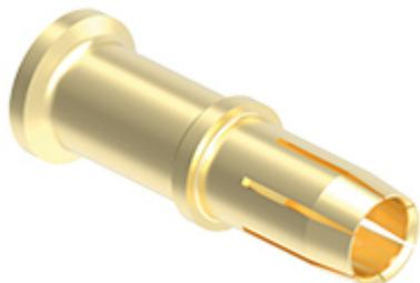
メス 圧着コンタクト, RX7 シリーズ, 70 A, 切削金メッキ, 導体断面積 16 mm<sup>2</sup>, AWG 6 - 5, HNM - 高嵌合回数バージョン
