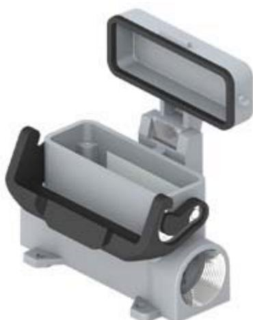
サーフェスマウントハウジング, IL-BRID シリーズ, 1レバー付, Pg21 x 2 ケーブルエントリー, サイズ "66.16", ハイコンストラクション, 金属カバー付
