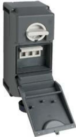
Presa con interruttore di blocco, serie TM, 3 poli + N + PE, 7 h (nero), 63 A, 480 ÷ 500 V, portafusibile sezionabile 22 x 58 mm, con scatola base
