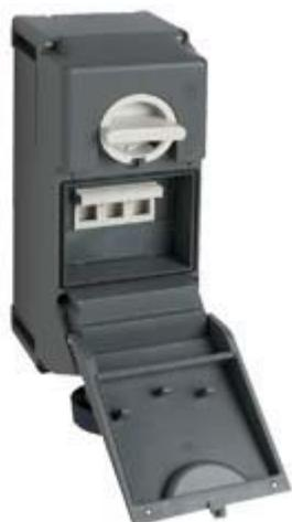
Presa con interruttore di blocco, serie TM, 3 poli + PE, 7 h (nero), 63 A, 480 ÷ 500 V, portafusibile sezionabile 22 x 58 mm, con scatola base
