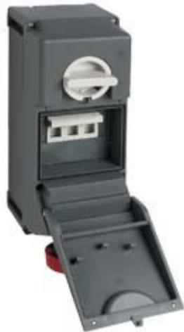
Presa con interruttore di blocco, serie TM, 3 poli + N + PE, 11 h (rosso), 63 A, 250/440 ÷ 265/460 V, portafusibile sezionabile 22 x 58 mm, con scatola base
