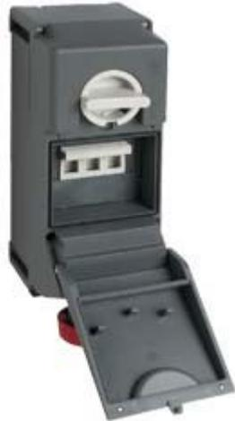
Presa con interruttore di blocco, serie TM, 3 poli + PE, 11 h (rosso), 63 A, 440 ÷ 460 V, portafusibile sezionabile 22 x 58 mm, con scatola base
