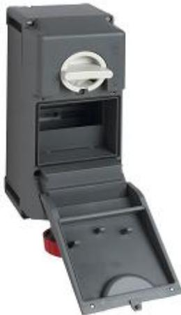
Presa con interruttore di blocco, serie TM, 3 poli + PE, 11 h (rosso), 63 A, 440 ÷ 460 V, con vano per apparecchi modulari, 6 moduli guida DIN EN 60715, con scatola base
