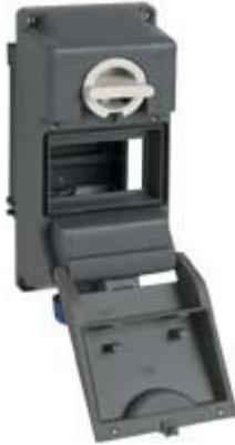
Presca con interruttore di blocco, serie TM, 3 poli + N + PE, 9 h (blu), 32 A, 120/208 ÷ 144/250 V, con vano per apparecchi modulari, 4,5 moduli guida DIN EN 60715, senza scatola base
