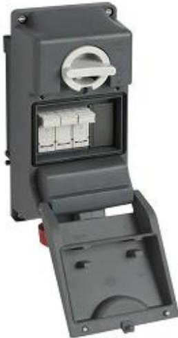
Presa con interruttore di blocco, serie TM, 2 poli + PE, 9 h (rosso), 32 A, 380 ÷ 415 V, portafusibile sezionabile 10 x 38 mm, senza scatola base
