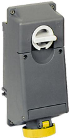
Presa con interruttore di blocco, serie TM, 3 poli + N + PE, 4 h (giallo), 32 A, 57/100 ÷ 75/130 V, senza portafusibili, senza scatola base
