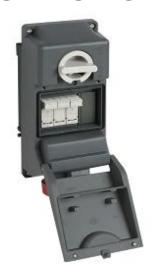
Presa con interruttore di blocco, serie TM, 3 poli + N + PE, 4 h (giallo), 32 A, 57/100 ÷ 75/130 V, portafusibile sezionabile 10 x 38 mm, senza scatola base
