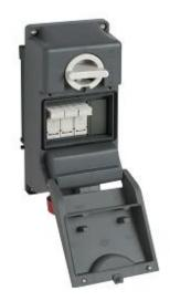
Presa con interruttore di blocco, serie TM, 3 poli + PE, 3 h (rosso), 32 A, 380 ÷ 380 V, portafusibile sezionabile 10 x 38 mm, senza scatola base
