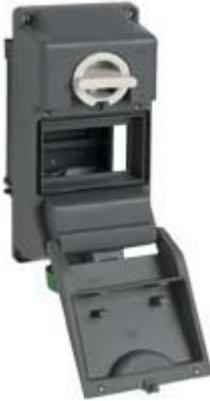
Presa con interruttore di blocco, serie TM, 3 poli + PE, 10 h (verde), 32 A, > 50 V, con vano per apparecchi modulari, 4,5 moduli guida DIN EN 60715, senza scatola base
