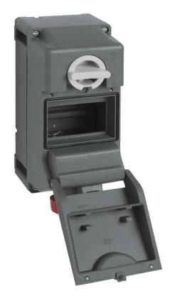
Presa con interruttore di blocco, serie TM, 3 poli + N + PE, 7 h (nero), 16 A, 277/480  $\div$  288/500 V, con vano per apparecchi modulari, 4,5 moduli guida DIN EN 60715, con scatola base
