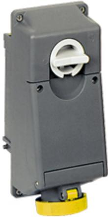
Presa con interruttore di blocco, serie TM, 3 poli + N + PE, 4 h (giallo), 16 A, 57/100 ÷ 75/130 V, senza portafusibili, senza scatola base
