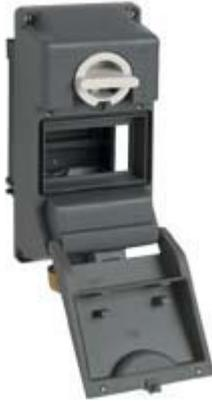
Presa con interruttore di blocco, serie TM, 3 poli + N + PE, 4 h (giallo), 16 A, 57/100 ÷ 75/130 V, con vano per apparecchi modulari, 4,5 moduli guida DIN EN 60715, senza scatola base
