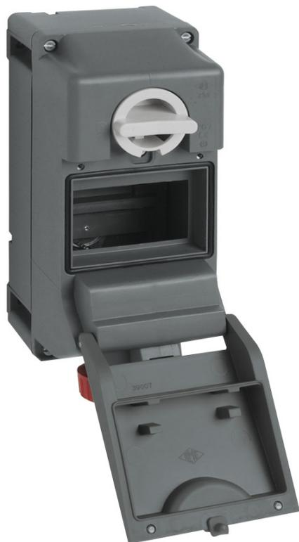
Presa con interruttore di blocco, serie TM, 3 poli + N + PE, 4 h (giallo), 16 A, 57/100 ÷ 75/130 V, con vano per apparecchi modulari, 4,5 moduli guida DIN EN 60715, con scatola base
