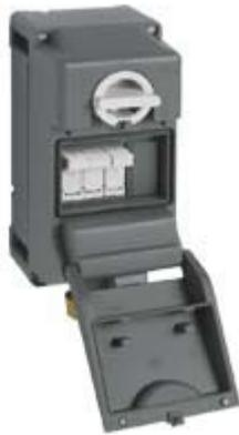
Presa con interruttore di blocco, serie TM, 3 poli + PE, 4 h (giallo), 16 A, 100 ÷ 130 V, portafusibile sezionabile 10 x 38 mm, con scatola base
