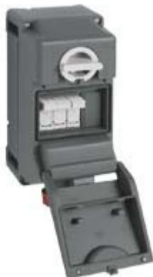
Presa con interruttore di blocco, serie TM, 3 poli + PE, 3 h (rosso), 16 A, 380 ÷ 380 V, portafusibile sezionabile 10 x 38 mm, con scatola base
