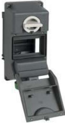
Presa con interruttore di blocco, serie TM, 3 poli + N + PE, 2 h (verde), 16 A, > 50 V, con vano per apparecchi modulari, 4,5 moduli guida DIN EN 60715, senza scatola base
