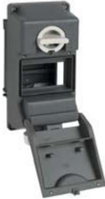
Presa con interruttore di blocco, serie TM, 2 poli + PE, 12 h (bianco), 16 A, con vano per apparecchi modulari, 4,5 moduli guida DIN EN 60715, senza scatola base
