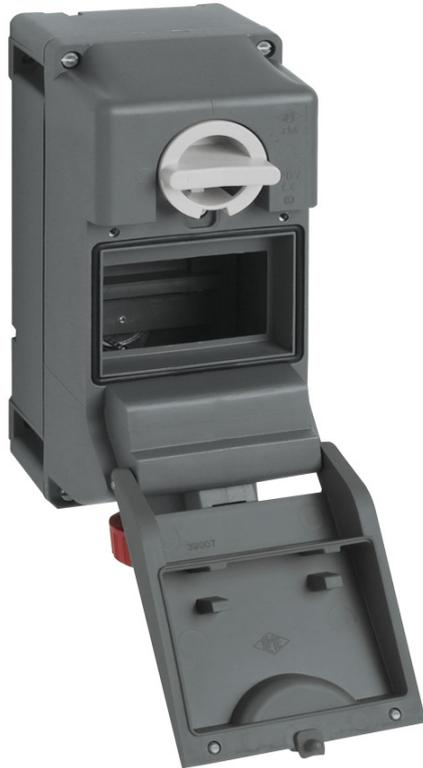
Presca con interruttore di blocco, serie TM, 2 poli + PE, 12 h (bianco), 16 A, con vano per apparecchi modulari, 4,5 moduli guida DIN EN 60715, con scatola base
