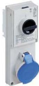
Presa con interruttore di blocco, serie SQV, 3 poli + N + PE, 9 h (blu), 32 A, 120/208 ÷ 144/250 V, portafusibile sezionabile 10 x 38 mm
