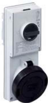
Presa con interruttore di blocco, serie SQV, 3 poli + PE, 7 h (nero), 32 A, 480 ÷ 500 V, portafusibile sezionabile 10 x 38 mm
