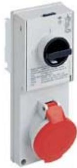
Presa con interruttore di blocco, serie SQV, 3 poli + N + PE, 11 h (rosso), 32 A, 250/440 ÷ 265/460 V, portafusibile sezionabile 10 x 38 mm
