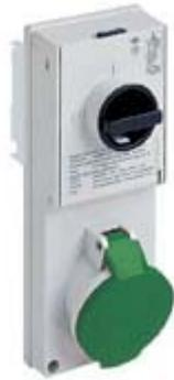
Presa con interruttore di blocco, serie SQV, 3 poli + PE, 10 h (verde), 32 A, > 50 V, portafusibile sezionabile 10 x 38 mm
