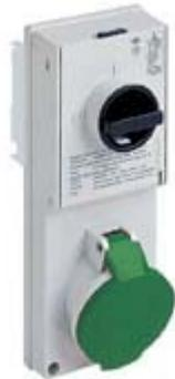
Presa con interruttore di blocco, serie SQV, 3 poli + PE, 2 h (verde), 16 A, > 50 V, portafusibile sezionabile 10 x 38 mm
