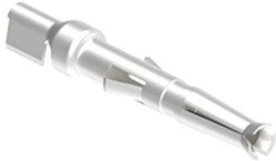
Contatto a crimpare femmina, serie SD, 10 A, stampato argentato, sezione conduttore 0,37 - 1 mm<sup>2</sup>, AWG 24 - 18, imballo in bandoliera, per 500 cicli di accoppiamento
