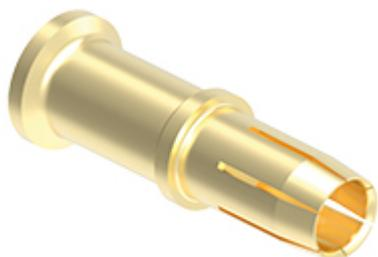
Contatto a crimpare femmina, serie RX7, 70 A, tornito dorato, sezione conduttore 25 mm<sup>2</sup>, AWG 4 - 3, versione HNM - High Number of Matings
