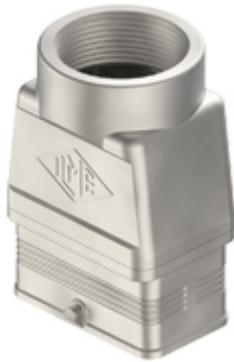
Custodia mobile, serie MIXO ONE, con 2 piolini, ingresso cavo verticale M25, 1 modulo, con morsetto di terra con terminale di connessione a vite
