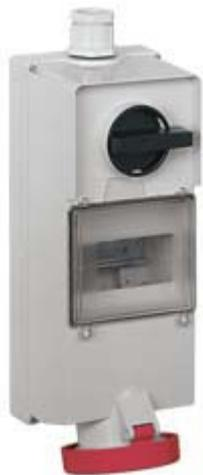
Presa con interruttore di blocco, serie IK, 2 poli + PE, 9 h (rosso), 63 A, 380 ÷ 415 V, con vano per apparecchi modulari, 7 moduli guida DIN EN 60715
