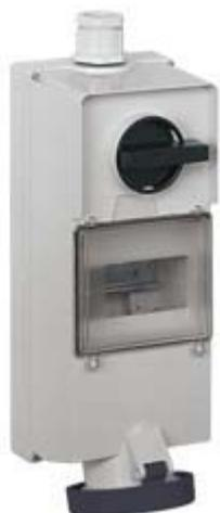
Presa con interruttore di blocco, serie IK, 2 poli + PE, 7 h (nero), 63 A, 480 ÷ 500 V, con vano per apparecchi modulari, 7 moduli guida DIN EN 60715
