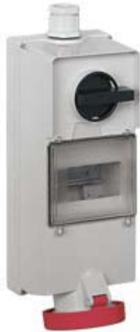
Presca con interruttore di blocco, serie IK, 3 poli + PE, 6 h (rosso), 63 A, 380 ÷ 415 V, con vano per apparecchi modulari, 7 moduli guida DIN EN 60715
