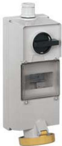
Presa con interruttore di blocco, serie IK, 3 poli + PE, 4 h (giallo), 63 A, 100 ÷ 130 V, con vano per apparecchi modulari, 7 moduli guida DIN EN 60715
