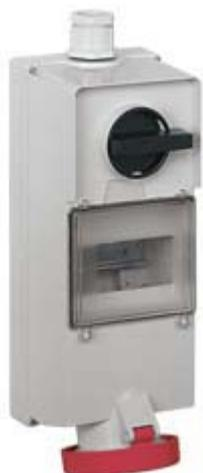
Presa con interruttore di blocco, serie IK, 3 poli + PE, 11 h (rosso), 63 A, 440 ÷ 460 V, con vano per apparecchi modulari, 7 moduli guida DIN EN 60715
