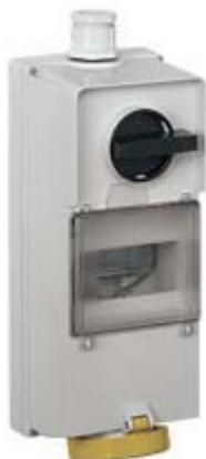
Presa con interruttore di blocco, serie IK, 3 poli + N + PE, 4 h (giallo), 32 A, 57/100 ÷ 75/130 V, con vano per apparecchi modulari, 7 moduli guida DIN EN 60715
