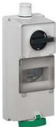
Presa con interruttore di blocco, serie IK, 3 poli + N + PE, 2 h (verde), 32 A, > 50 V, con vano per apparecchi modulari, 7 moduli guida DIN EN 60715
