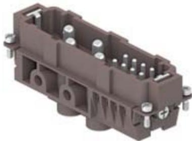
Frutto spina, serie CX RY, connessione con morsetto a vite, 4 + 8 poli + PE, 80 A 400 V 6 kV 3 / 16 A 230/400 V 4 kV 3, grandezza "104.27", per applicazioni fino a 180°C
