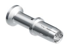
Contatto a crimpare femmina, serie CX7, 70 A, tornito argentato, sezione conduttore 16 mm², AWG 6 - 5, conduttore classe 6 extra-flessibile
