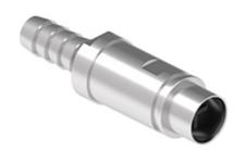
Contatto pneumatico metallico femmina, dritto, con portagomma, con valvola di chiusura, diametro interno 8,0 mm
