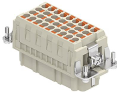
Frutto presa, serie CQEY, connessione rapida AXYR® push-in con morsetto a molla, 32 poli + PE (33-64), 16 A 500 V 6 kV 3, grandezza "77.62"
