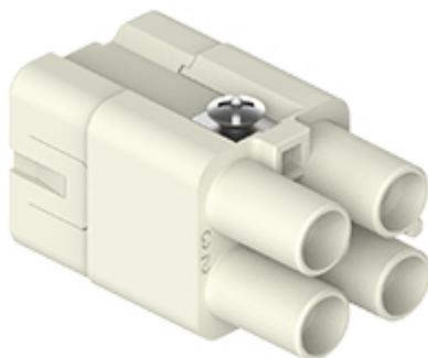
Frutto presa, serie CQ, connessione a crimpare, 3 + 2 poli + PE, 40 A 400 V 6 kV 3 / 10 A 250 V 4 kV 3, grandezza "21.21"
