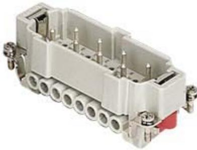
Frutto spina, serie CME, connessione con morsetto a vite, 6 + 2 poli + PE (17-32), 16 A 830 V 8 kV 3 / 16 A 500 V 6 kV 3, grandezza "77.62", senza piastrina
