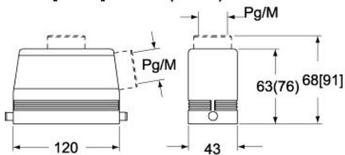
**CHV LG (CAV LG), MHV LG (MAV LG) [MFV LG]**
