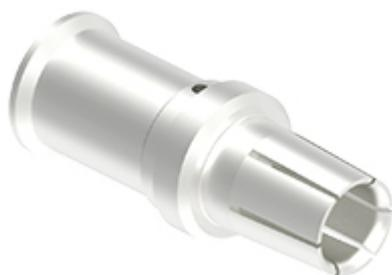
Contatto a crimpare femmina, serie C30, 300 A, tornito argentato, sezione conduttore 25 mm<sup>2</sup>, AWG 4
