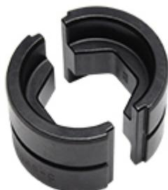
Matrici di crimpatura, per contatti 300 A, per contatti con sezione 95 mm<sup>2</sup> (AWG 3/0)
