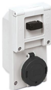
Presa con interruttore di blocco, serie BK, 2 poli + PE, 7 h (nero), 32 A, 480 ÷ 500 V, portafusibile sezionabile 10 x 38 mm
