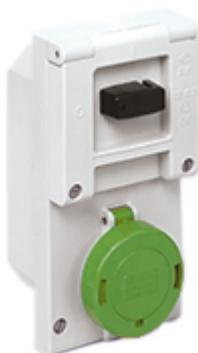
Presa con interruttore di blocco, serie BK, 3 poli + N + PE, 2 h (verde), 32 A, > 50 V, portafusibile sezionabile 10 x 38 mm
