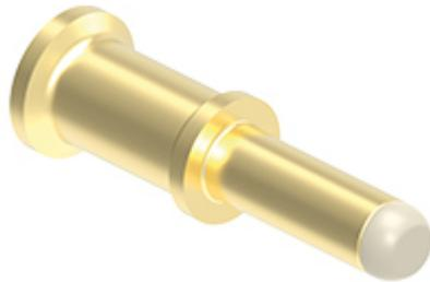
Buchsenkontakt, 16mm<sup>2</sup>, gold HNM, Crimpanschluss, 70A, Baureihe RX7 , extra flexibler Leiter der Klasse 6, fingersichere ausführung
